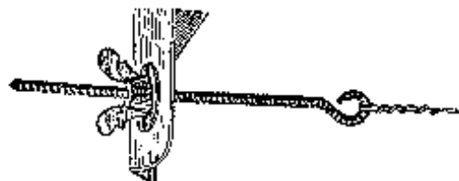
Fig. 84. — Spanner met vijzen.
