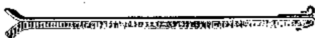
Fig. 448. — Steunsel in T ijzer, voor beschutting, met haak, waaraan de ijzerdraad gehecht is, nodig voor het gebruik van het zeil.
